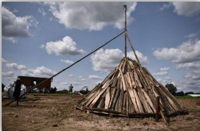
[6 Bilder](#) Der Kohlenmeiler steht auf einem sogenannten „Rost“ – diese Holzkonstruktion sorgt für Luft von unten. Die Stange in der Mitte gibt dem Holzkegel Stabilität. *Foto: Weingand / STZN*
