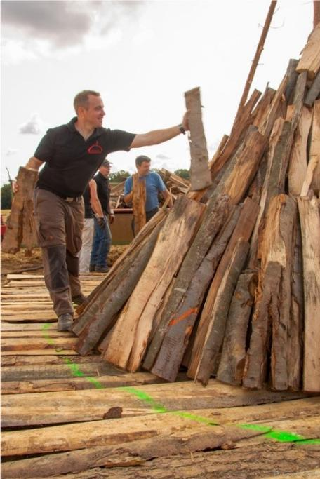
Danach wird das Holz um diesen Kern bis zum zweiten Kreis, der den endgültigen Umfang des künftigen Kohlenmeilers markiert, aufgeschichtet, anschließend darauf wieder in zweiter Ebene. Dabei wird darauf geachtet, möglichst wenig Hohlraum entstehen zu lassen, die Holzscheite also möglichst dicht zu packen und Hohlräume durch kleinere Scheite auszufüllen. Als unzuweckmäßig haben sich ungespaltene Rollen erwiesen, da hier die Hohlräume zu groß würden und die Statik des Kohlenmeilers litte.
