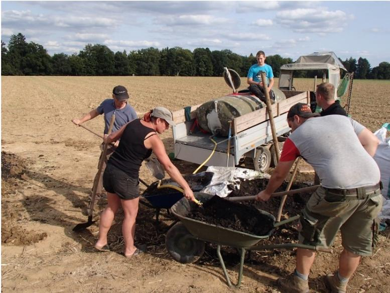
Die Lösche ist eine Mischung aus nicht zu tonigem, humusreichem Erdboden, vermischt mit Sand, Kohlenstaub und Holzkohlestückchen. Diese Lösche wird nun mit Wasser zu einem zähen Brei angerührt. Dieser sollte nicht zu trocken und auch nicht zu nass sein, um gut auf der Meiler-Oberfläche zu haften.
