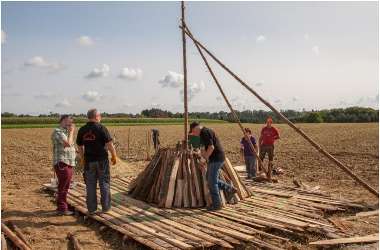
In der Mitte des Rosts wird die Richtstange aufgestellt, die die Mittelachse des Kohlenmeilers darstellt und als Orientierung bei der Aufschichtung dient.
