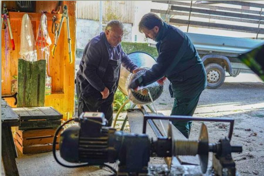
Also entwickelte er eine Eigenkonstruktion, aber nicht mit dem Schlepper, sondern kleiner und leichter mit einem Elektromotor und einer Seilwinde. "Seither ist "Weihnachtsbaum verpacken" ein Kinderspiel" meint er schmunzelnd.
