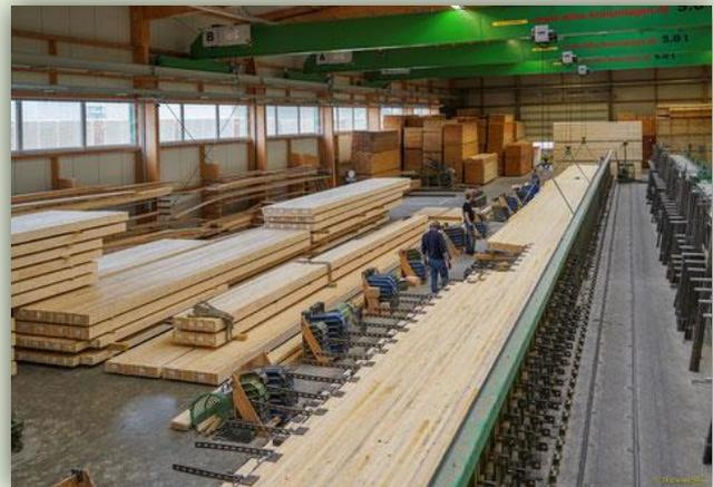
der riesigen Brückenteile führte der Gang durch die Fabrikation in die Abbundhalle, wo jede der äußerst vielfältigen Brettschichtholz-Konstruktionen, von der Brücke bis zum Schönbuch-Aussichtsturm ihren ganz individuelle Feinbearbeitung erfährt.
