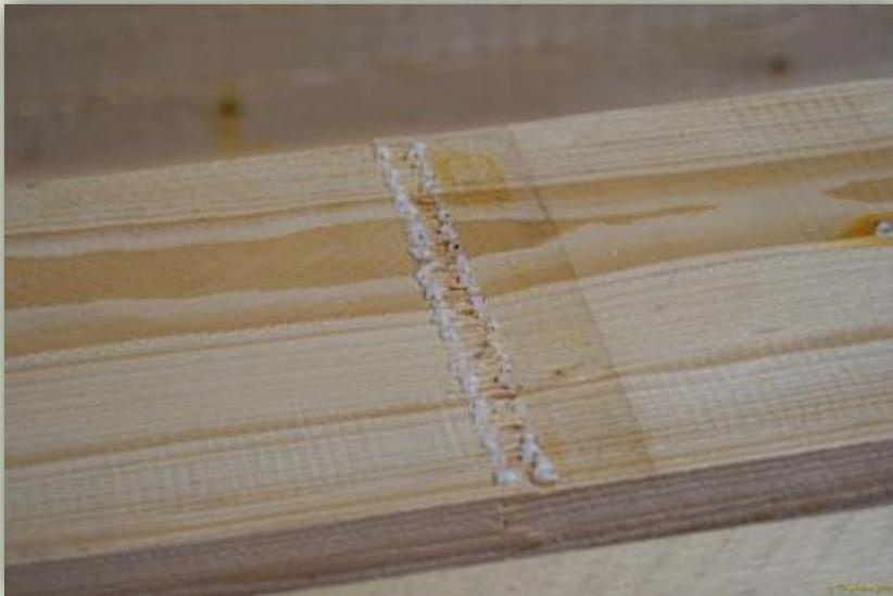
Die Lamellen mit der gewünschten Qualität werden nun in der ebenfalls automatischen Keilverzinkungsanlage verzinkt (*Erzeugen kammartiger Schnittkanten, um die Kontaktfläche zu vergrößern*) und hintereinander miteinander verleimt. So entstehen theoretisch endlose Bretter. Praktisch liegt die Maximallänge bei 45 Metern.
