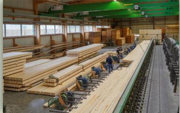
*Hydraulische Verpressung in die gewünschte Form*
