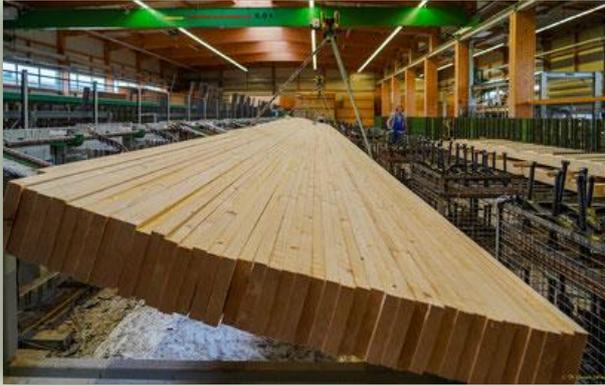
*Transport des Brettschichtstapels zur Pressanlage*
