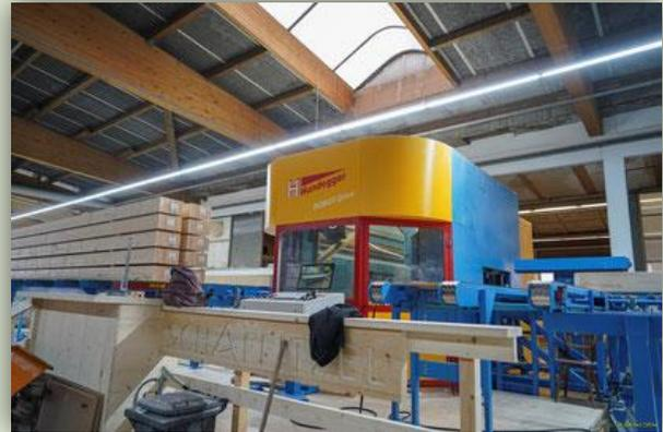
Hundegger Robot Drive - ein Abbund-Roboter
